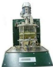
Вихревые биореакторы для нужд биотехнологической промышленности. Реакторы используются для выращивания микроводорослей, ПАК на основе вихревых биореакторов для выращивания стволовых клеток.
